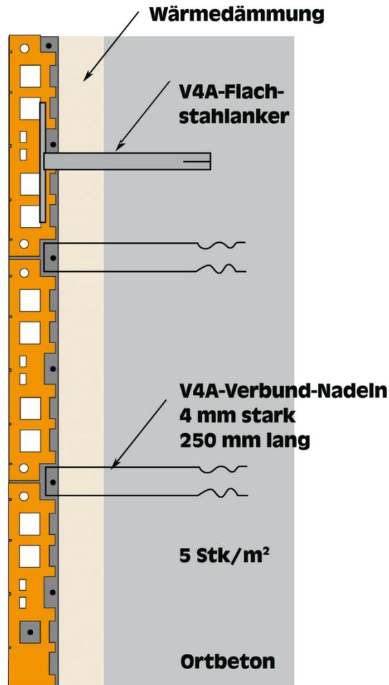
Ziegelblenden 60 mm stark mit Baustahl bewehrt und mit Leichtbeton verfüllt.
