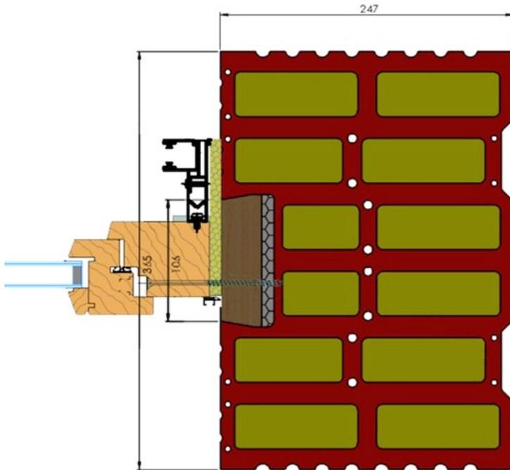
Durch seine thermische Trennung gewährleistet der Fensterbefestigungsziegel ohne Anschlag eine sichere Montage des Fensters, egal ob mit Rollladen-, Jalousiekasten oder WU-Sturz
