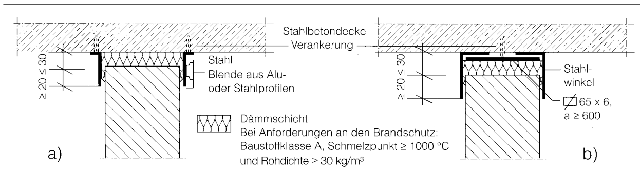
Abb. 6: Gleitende Deckenanschlüsse mit Stahlwinkel (Vertikalschnitte). Angegebene Maße in mm. Stahlprofile a) außenliegend, b) innenliegend
